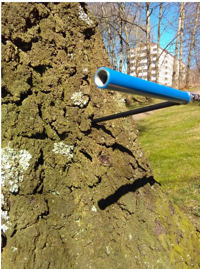
Figur 5.3 – Provtagning av träd med hjälp av tillväxtborr.
