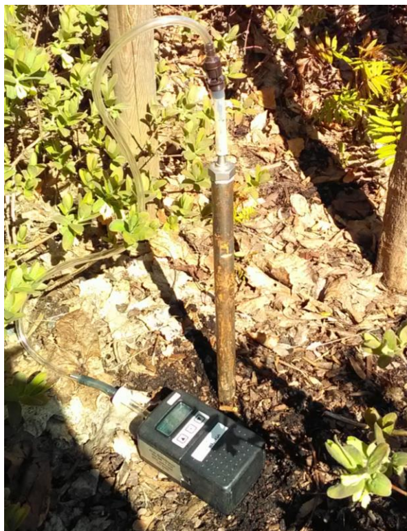
Figur 5.2 – Installerad porluftsspets och pump för aktiv provtagning av porluft genom kolrör.
